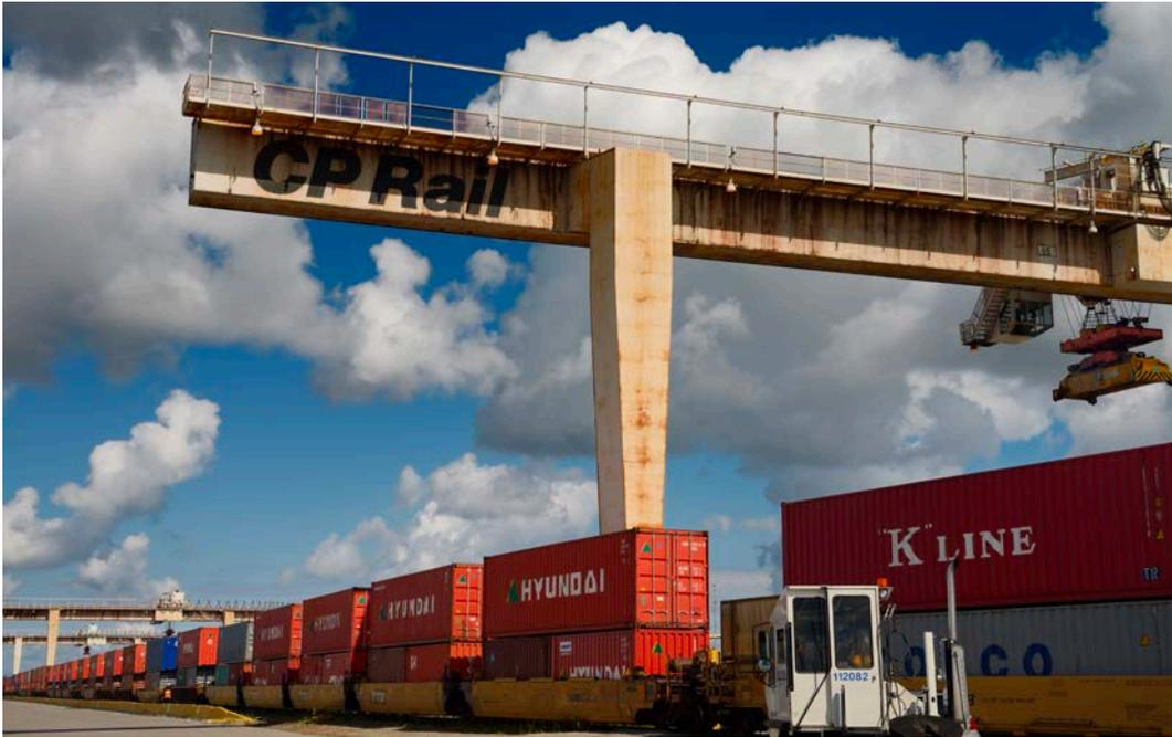
图 24. 双层货运火车的图例
